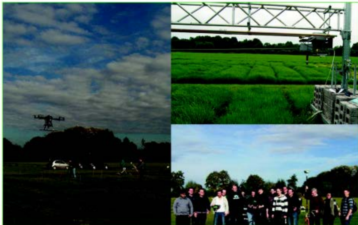
Abbildung 118: Testeinsatz verschiedener Sensoren der Fernerkundung und Überfliegen der unterschiedlich gedüngten Versuchsanlage von Haus Riswick mit einer mit Hyperspektralkamera ausgestatteten Drohne
