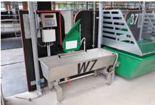
Neben der Registrierung der individuellen Futteraufnahme von Kraftfutter und Grundfutter wird zusätzlich auch die individuelle Wasseraufnahme der Milchkühe registriert.
