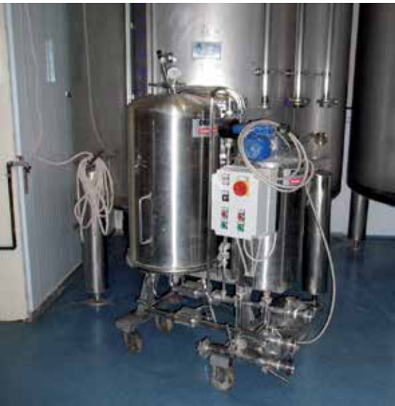
Filteranlage: Die VO 203/2012 schreibt für die Filtration von Weinerzeugnissen eine Mindestporengröße von 0,2 µm vor. Damit ist der Einsatz der Ultra- oder Nanofiltration verboten.
