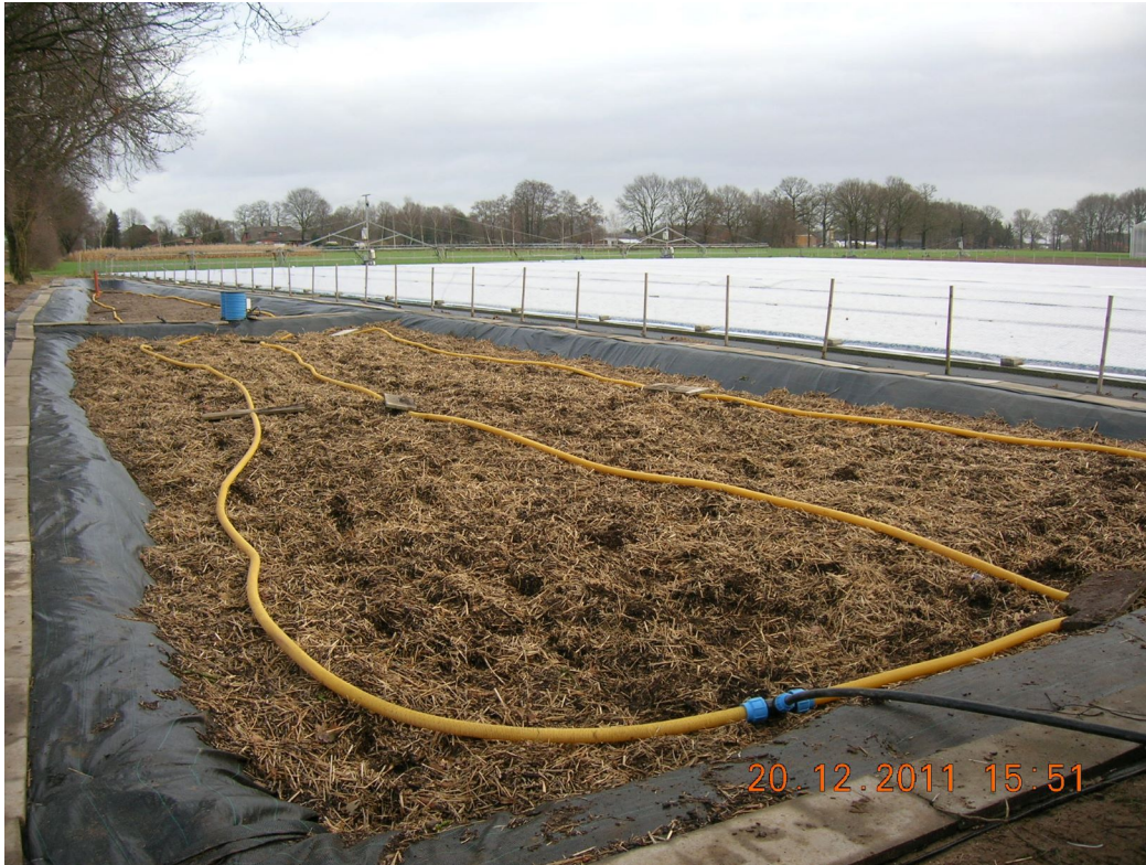
Abbildung 6: In der Pilotanlage 2011 bestand das Substrat zu 1/3 aus Stroh.
