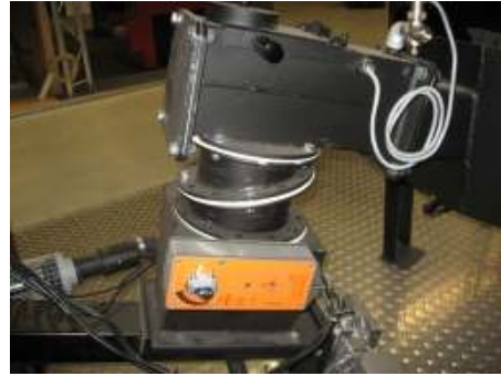
Rückbrandklappe mit Wasserlöscheinrichtung (Fröling Österreich)
