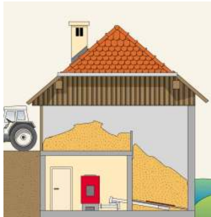
Hackgutlagerung über dem Heizraum
