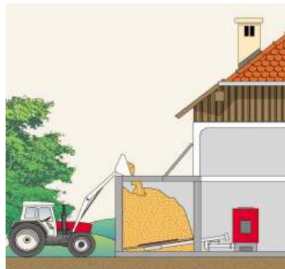
Hackgutaustragung mit angebautem Lagerraum
