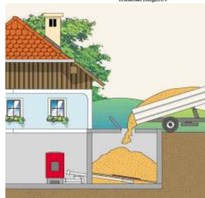
Anbau für Hackgut Raumaustragung
